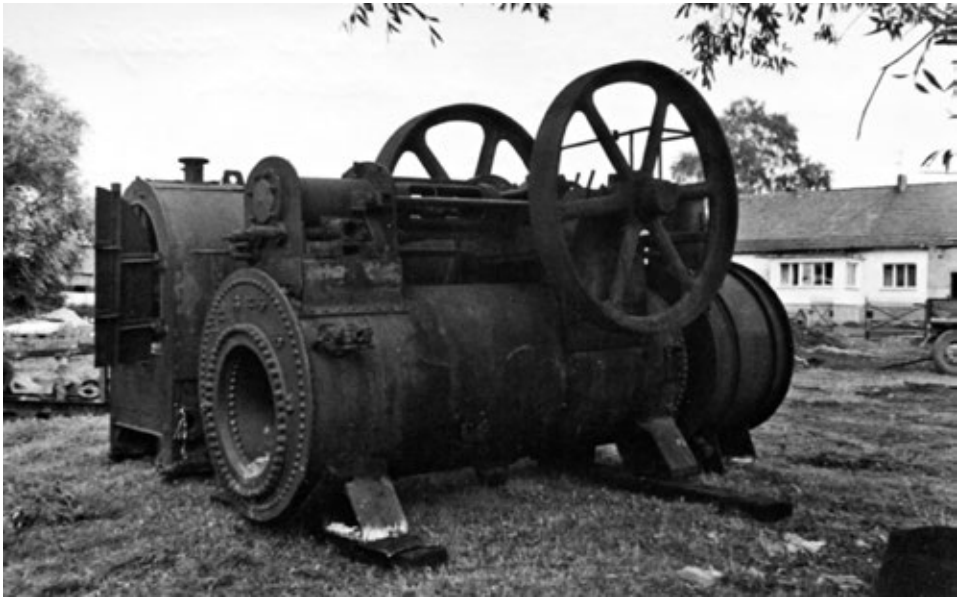
Lokomobila służąca do napędu różnego rodzaju maszyn. Była to przewoźna maszyna parowa. Foto. Witold Flisiński
